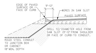
SAW SLOT EDGE OF PAVEMENT TRANSITION
